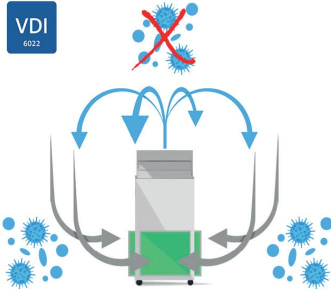
Die mobile und energiesparende Umluftabsauganlage mit Hochvolumenstrom-Schwebstofffilter für Reinräume (HEPA 14) sorgt für eine staubfreie, aerosolfreie und sichere viren-/ bakterienfreie Luft in Ihren Räumen.
